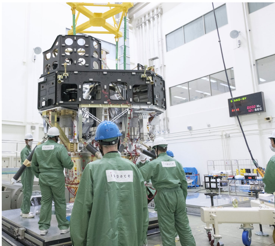
経産省SBIR事業の補助により開発中のULTRAランダーの振動試験時の写真
