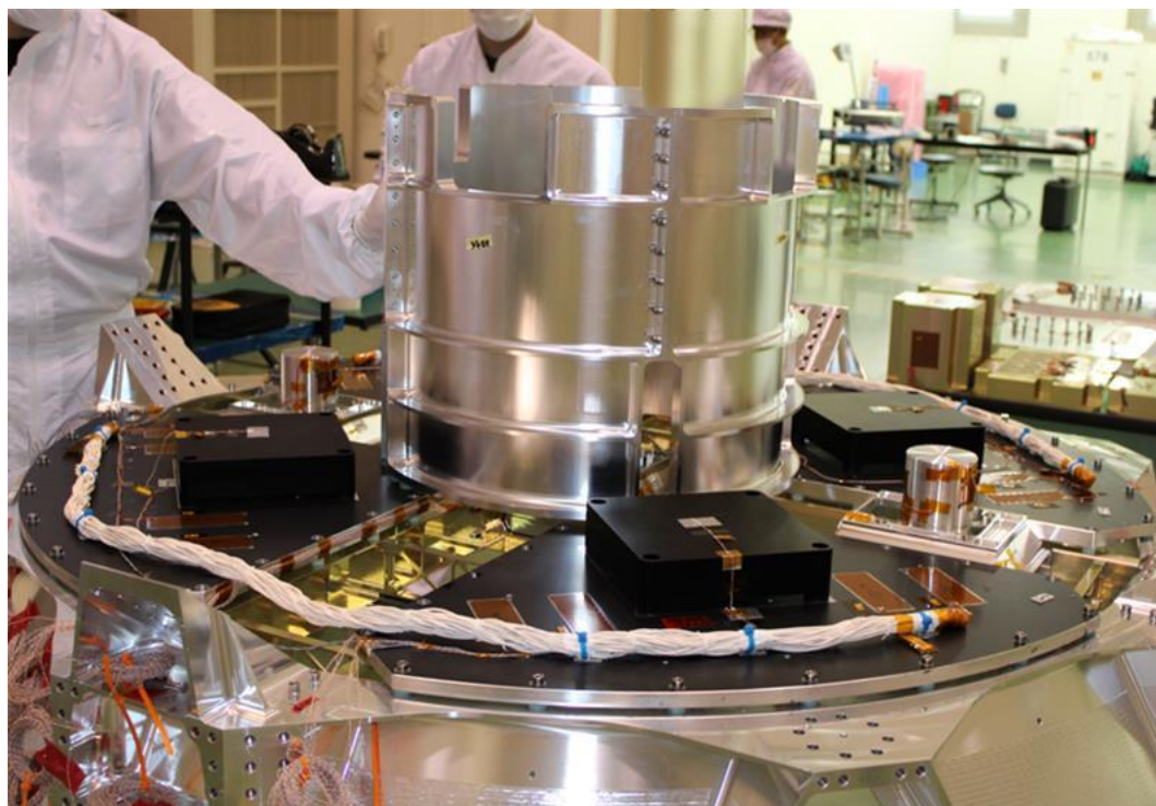
仮称Series 3ランダーの熱構造モデル
