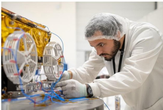
当社欧州法人のエンジニアがマイクロローバーの環境試験の準備をする様子
