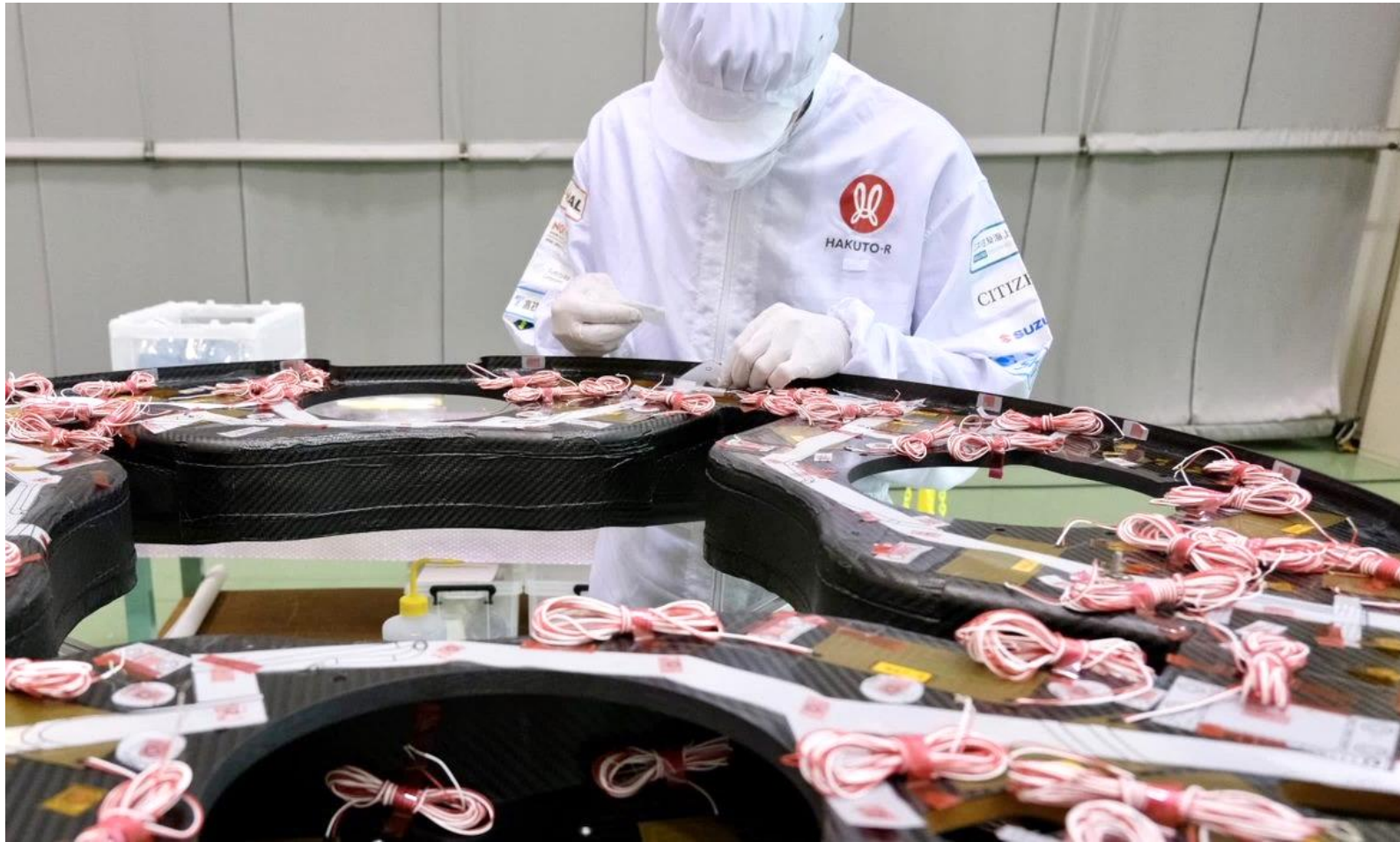
左図:ランダー(月着陸船)の底面のPSPというパーツにヒーターを取付作業している様子
