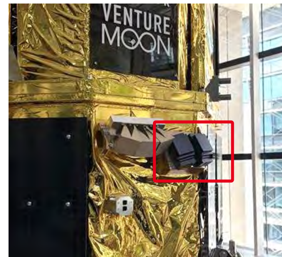
上記写真 赤枠がLRF。ランダーの側面に設置されている
