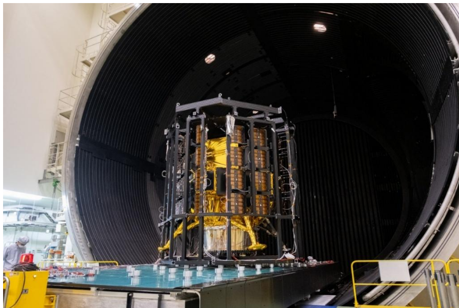
筑波にある JAXA 設備にて、直径 13 メートルの大型チャンバーに運ばれる 熱真空試験用ヒーターに包囲されたシリーズ 3 ランダー（仮称）の熱構造モデル（STM）
