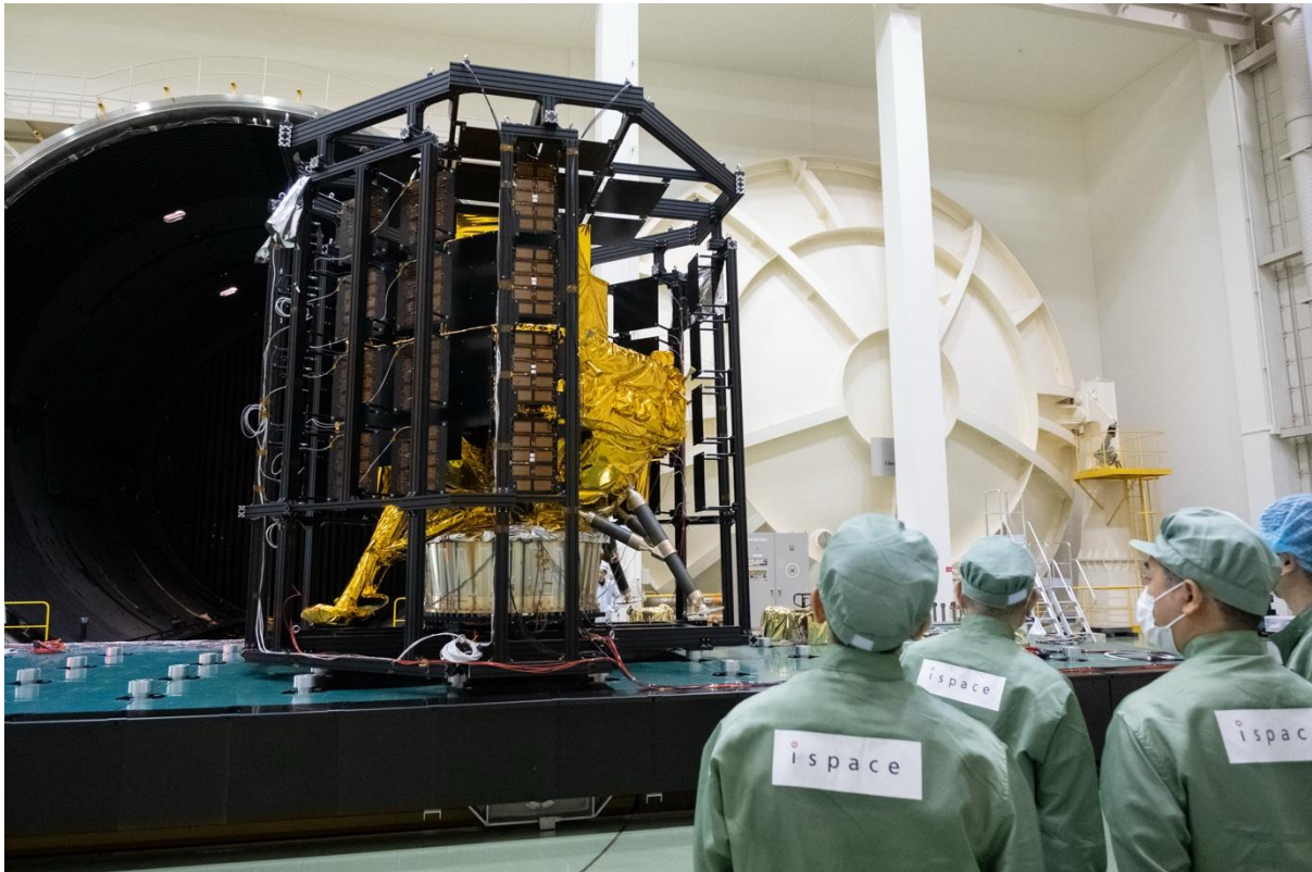
筑波にある JAXA 設備にて、シリーズ 3（仮称）ランダーの熱構造モデル（STM）が 熱真空試験大型チャンバーから搬出される様子
